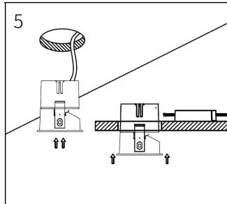
5.向上翻起两侧弹片，将灯具慢慢放入安装孔并调整好位置完全覆盖开孔，确保灯具安装正确稳妥。
