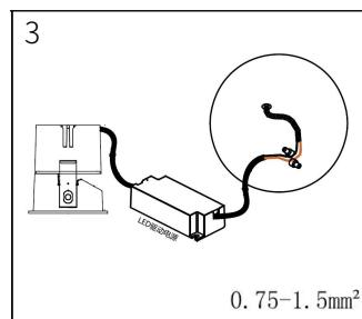
3.接线 按图所示接好输入电源，并确保接线正确。
